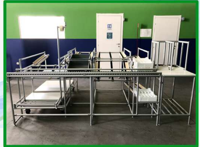
Postazioni di lavoro in alluminio, per due operatori, con corsie di presentazione componenti per inscatolamento / preparazione packaging.
