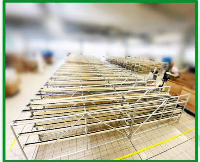
Rulliere a gravità in alluminio per stoccaggio contenitori e scatole dotate di sistema frontale a sbalzo per agevolare gli operatori nelle fasi di prelievo dei prodotti tramite appositi carrelli.
