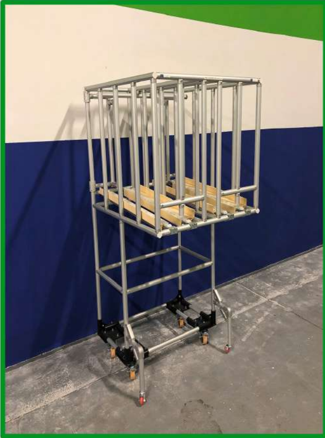
Struttura Lean dinamica in alluminio per trasporto kit scatole per packaging di fine linea.
